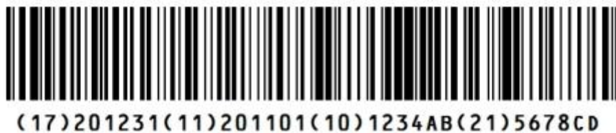
图4 包含 UDI-DI (上) 和 UDI-PI (失效日期、生产日期、生产批号和序列号) (下) 并联的 GS1-128 码
