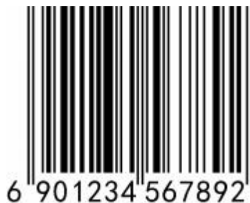
图1 仅包含UDI-DI的EAN-13码
