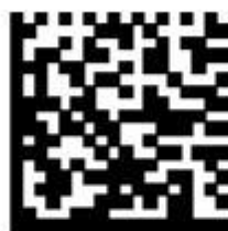
图4 包含 UDI-DI (上) 和 UDI-PI (失效日期、生产日期、生产批号和序列号) (下) 并联的 GS1-128 码
