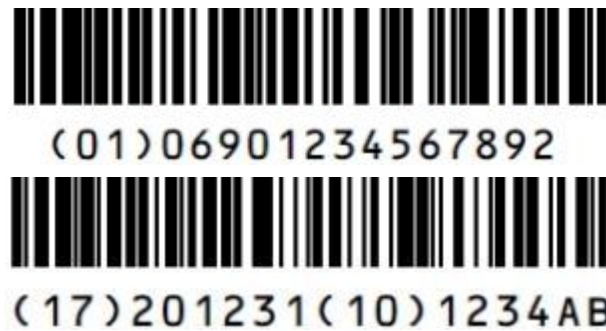
图3 包含 UDI-DI (上) 和 UDI-PI (失效日期和生产批号) (下) 并联的 GS1-128 码
